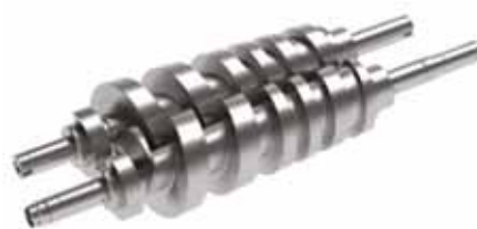
3. ábra: Változó menetemelkedésű és sűrítő-térfogatú kúpos csavarpár
